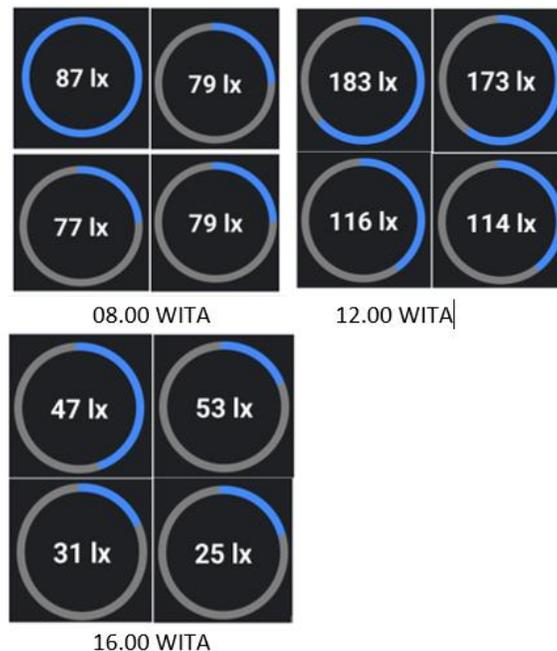
Gambar 3. Hasil Pengukuran Intensitas Cahaya tiap sudut pada Pukul 08.00 WITA, 12.00 WITA dan 16.00 WITA
