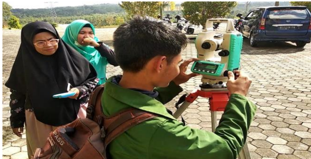
Gambar 3. Proses Mengunci Theodolite Dengan Sekrup Horizontal Clamp
